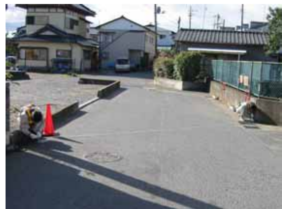
水平距離の測定(基準点～引照点)
