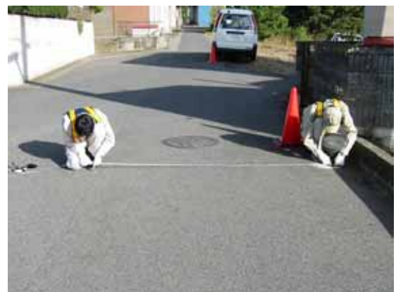
水平距離の測定(D引照点～基準点)
