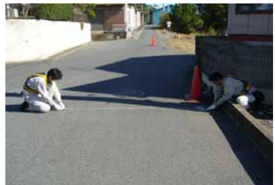
水平距離の測定(D引照点～基準点)
